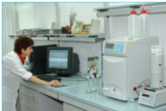
Калинка Благоева, ръководител на лаборатория в Електропроизводство – 2, по време на работа на йонен хроматограф – ДХ 120
