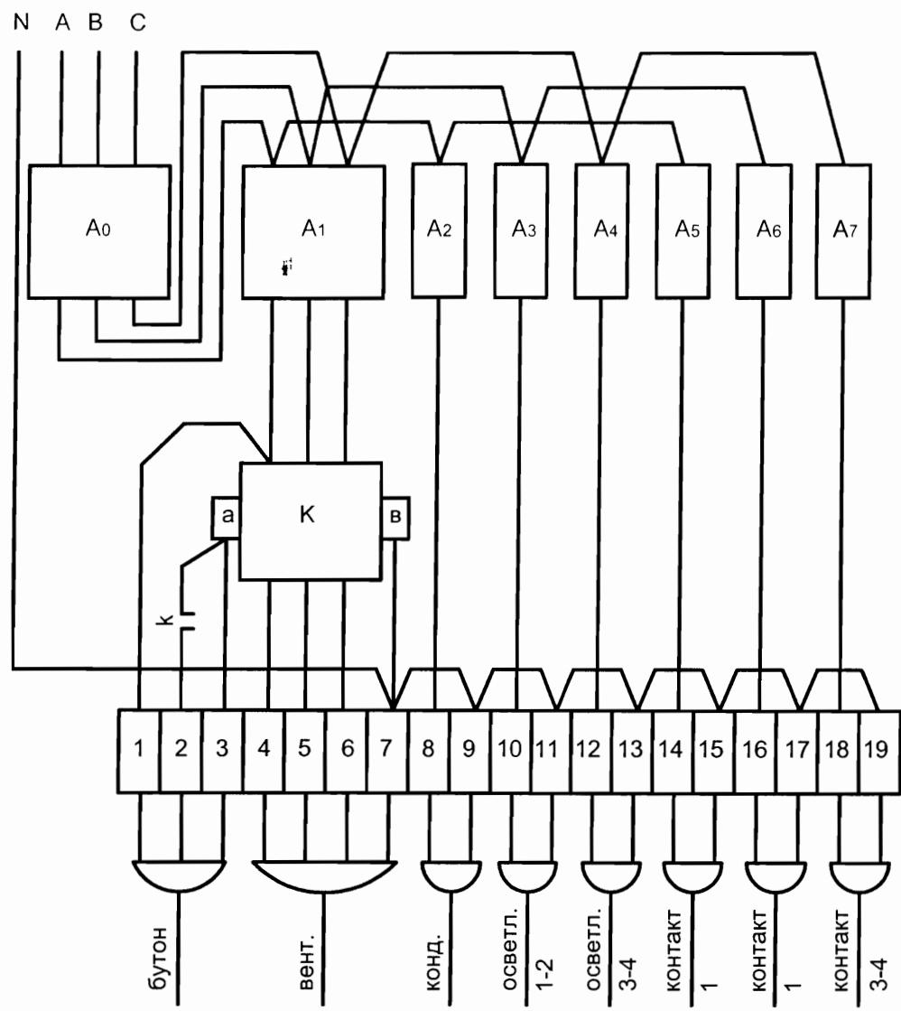
A<sub>0</sub> - Автоматичен прекъсвач тип E23G50
