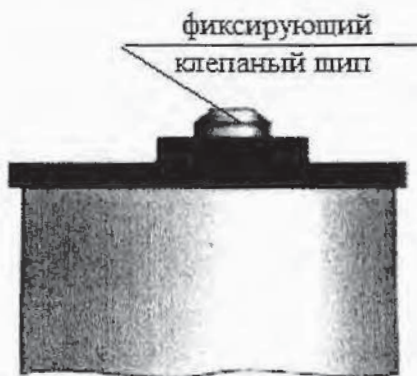
Рис. 6 – Накладной бандаж с зафиксированным клепаным шипом
