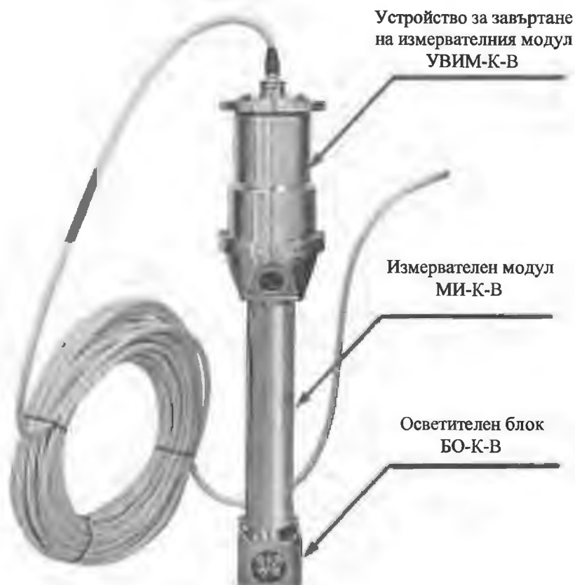
Фигура 1 Външен вид на телевизионната сонда ЗТ-К-В
