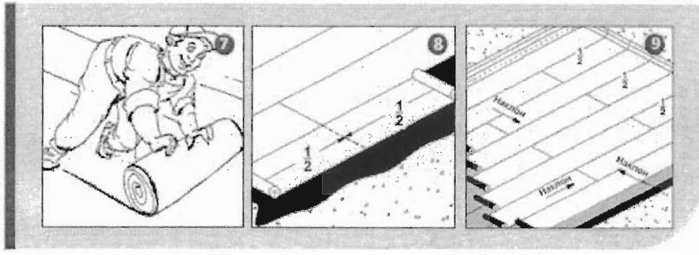
10. Равномерно се нагряват мембраната, ивицата на застъпване и грундиранията повърхност. Застъпванията трябва да са: странични - 10 см; челни - 15 см. В зоните на застъпване да се получи битумен разлив от 0.5 - 1 см.
