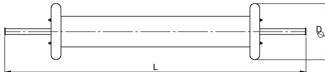
Фиг. 4 Схематична скица на блокиращия импеданс
