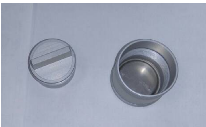
б) – Установка контрольного источника в держатель
