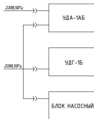
Рисунок А.2 – Схема подключения и габаритные размеры в случае работы установки УДГ-1Б с насосным блоком БН-01 и установкой УДА-1АБ
