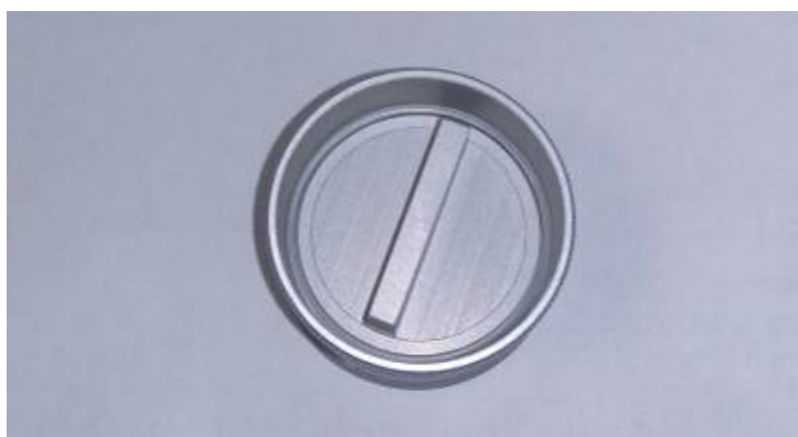
в) – Закрепление контрольного источника в держателе
