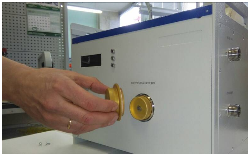
а) – Снятие защитной крышки
