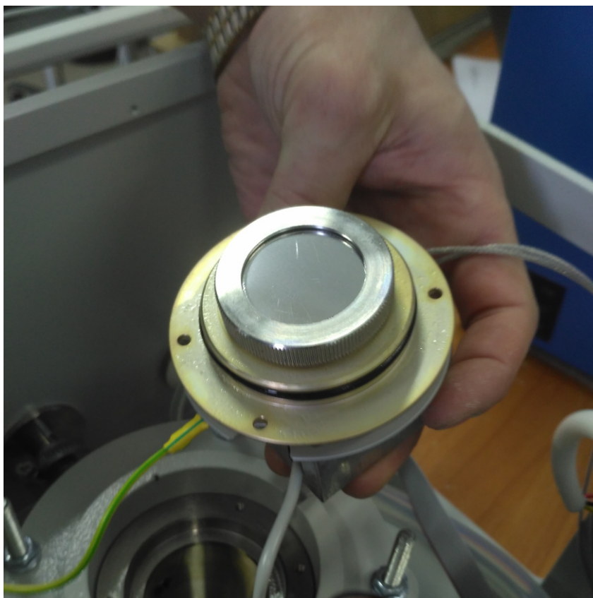
б) – Снятие блока детектирования
