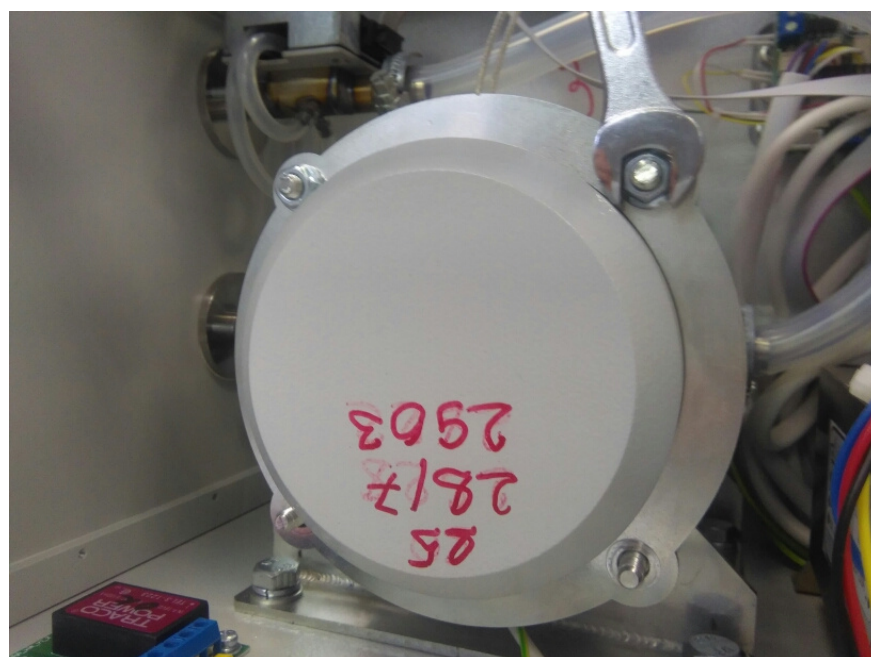
а) – Откручивание крепежных гаек защиты блока детектирования
