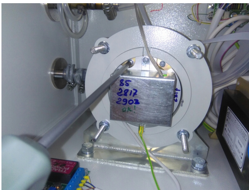
а) – Откручивание крепежных винтов блока детектирования
