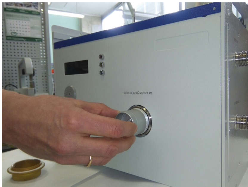
Рисунок 4.3 – Установка контрольного источника на штатное место
