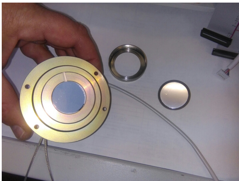
Рисунок 3.4 – Замена защитного кольца с плёнкой
