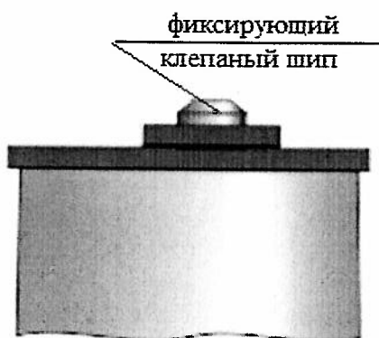
Рис. 6 – Накладной бандаж с зафиксированным клепаным шипом
