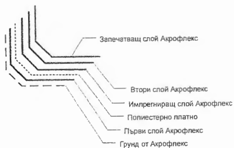
Детайл 2 /хидроизолация/
