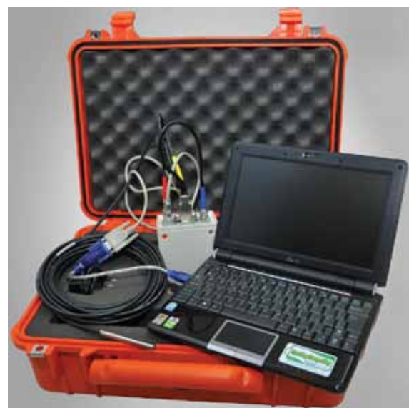
Портативната гама-спектрометрична система за контрол на обогатяването на свежото ядрено гориво, използвана в АЕЦ “Козлодуй”
