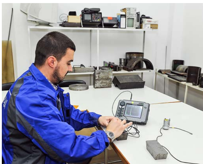
Осъществяване на ръчен ултразвуков контрол
