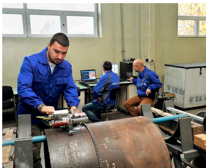
Провеждане на ултразвуков автоматизиран контрол
