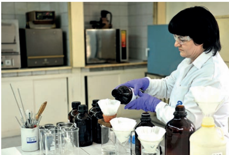
Предварителна подготовка на проби – филтриране на води от сондажни кладенци
