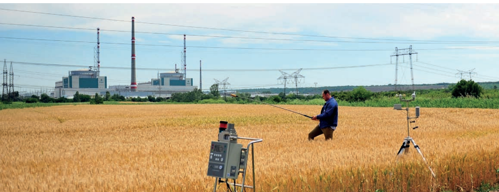
Полеви измервания на аерозоли и на радиационен гама-фон в Зоната за превантивни защитни мерки на АЕЦ "Козлодуй"
